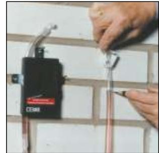
No llene la manguera completamente, 30 cm deben quedar libres. Conecta la manguera al aparato. Enciende la electrónica. La lámpara de control se enciende e indica que está lista para funcionar.
