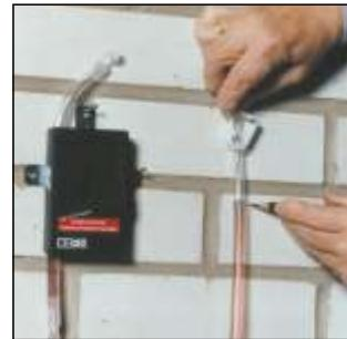
Nie napełniać całkowicie węża, 30 cm powinno pozostać wolne. Podłączyć wąż do urządzenia. Włączyć elektronikę. Lampka kontrolna zapala się i sygnalizuje gotowość do pracy.
