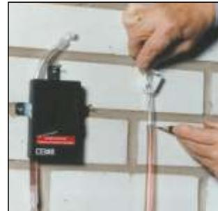
Nu umpleți complet furtunul, 30 cm trebuie să rămână liber. Conectați furtunul la dispozitiv. Porniți electronica. Lampa indicatoare se aprinde și arată că este pregătită pentru funcționare.
